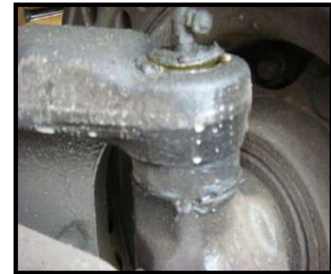
キングピンの破損
